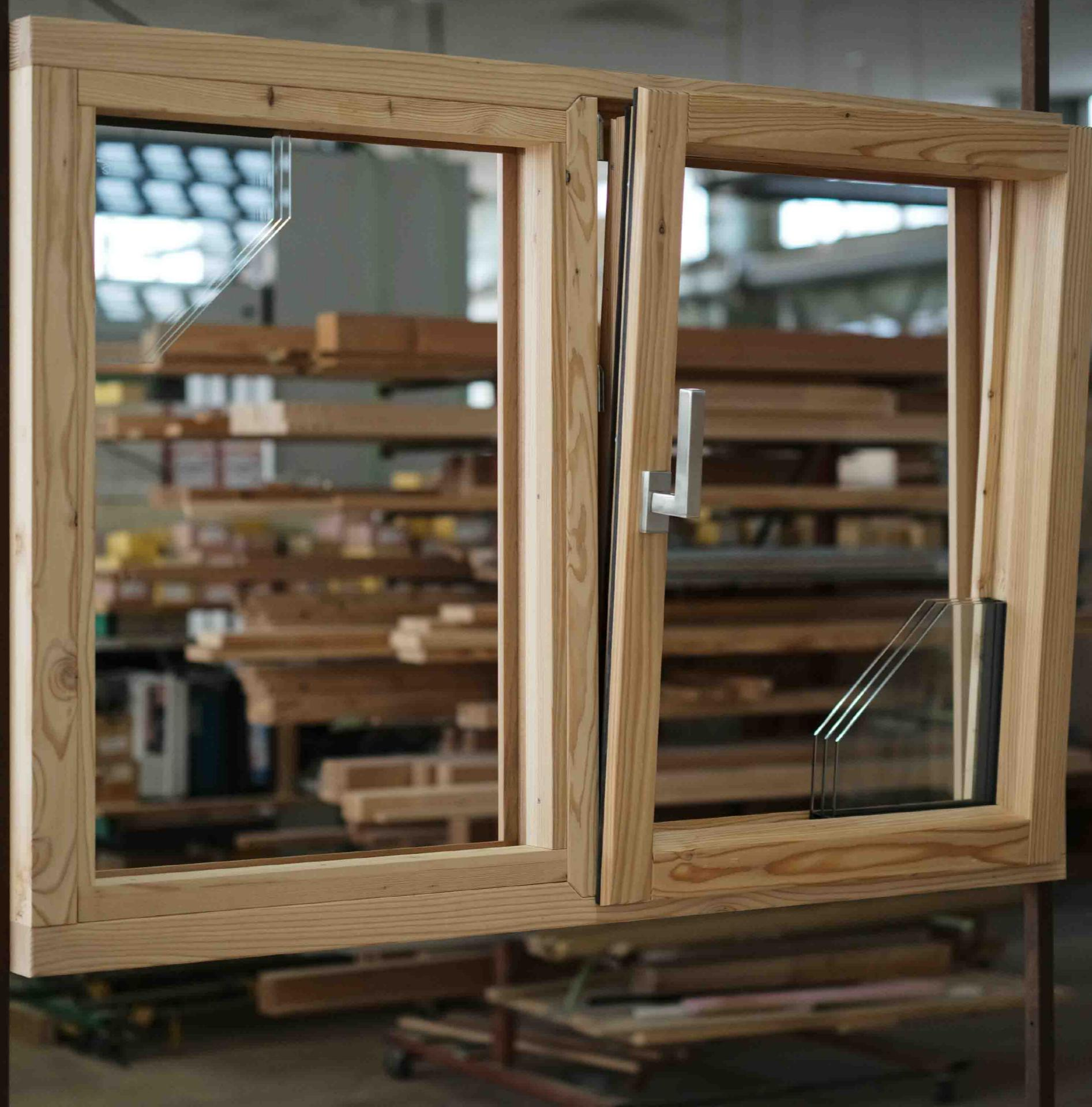
そこで、CURATIONER ではこのパッシブハウス認定基準を満たす木製サッシの開発に取り掛かりました。まず、機構には断熱性能が高いドレーキップを採用しました。フレーム性能を高めるためには見付面積を可能な限り細くすることと同時に、それに対して必要なフレーム性能や強度が確保できるまで見込み方向を大きくしていく必要があります。細くしそうでも窓としての強度が確保できない、強度を優先しすぎても性能を満たさなくなってしまうといったバランスを解析ソフトを用いながら調整し、断面形状を選定してきました。また、国内で作られているパッシブハウス認定基準を満たした窓はフレーム全体や外部面等に樹脂やアルミが使われていますが、CURATIONER では製造時の CO<sub>2</sub> 排出量も最低限に抑える必要があると考え、フレームを全て木材で完結させることを目指しました。
